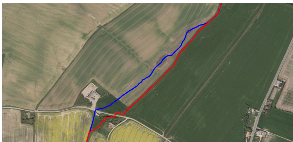
Figur 6.3. Forslag til nyt tracé (blå streg). Rød streg er Holmgård Mølle Ås nuværende forløb.
